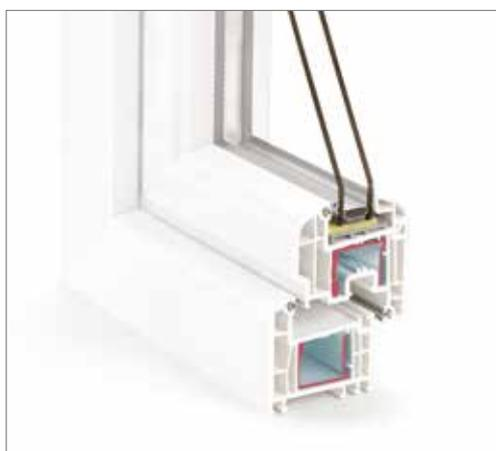
L'épaisseur idéale de 70 mm ainsi que la technique des 5 chambres permettent une isolation thermique efficace.
